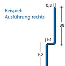
Der Blanke•AQUA-KEIL WAND, Gefälle-kante aus Edelstahl für die perfekte Detaillösung an Gefälleflächen zum Anschluss an Wände bei Linientwässerungen. Als rechte und linke Ausführung erhältlich.
