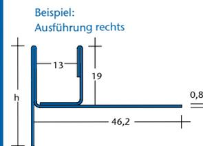
Ausgestattet mit einem Profil zur Aufnahme von Glastrennwänden (z. B. an Linientwässerungen) ermöglicht der Blanke•AQUA-KEIL GLAS, eine Gefälle-kante, als formschöne Gestaltung bodengleicher Duschen.
