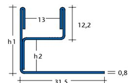
Das Glashalteprofil Blanke•AQUA-GLAS aus hochwertigem Edelstahl ermöglicht eine einfache und formschöne Anbringung von Glaswänden an Wand und Boden – ganz ohne Bohren und Zuschneiden von Fliesen. Im Vergleich zur herkömmlichen Vorgehensweise ist eine zerstörungsfreie und wasserdichte Verankerung gewährleistet.
