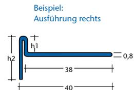
Für die perfekte Detaillösung an Gefälleflächen zum Anschluss an Böden bei Linientwässerungen: der Blanke•AQUA-KEIL. Die Gefälle-kante aus Edelstahl ist als rechte und linke Ausführung erhältlich.
